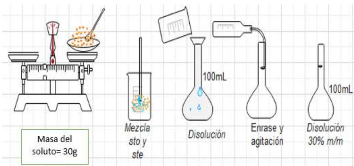
La preparación de las diferentes soluciones de concentraciones físicas o de concentración química, podemos prepararlos en el laboratorio paso a paso como describimos en el gráfico.
